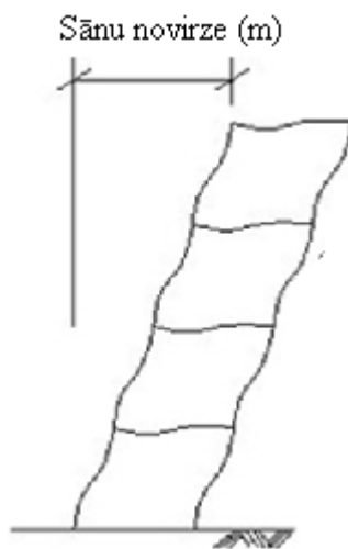
2.1. att. Jumta sānu novirze vai horizontālais pārvietojums
