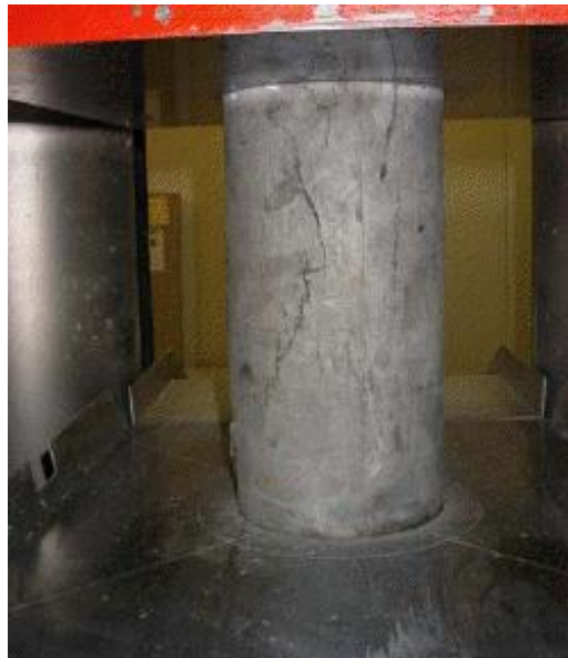
att. 2.6 Sevišķi augstas stiprības betona cilindrs ar 2.5% šķiedru sastāvā [19]
